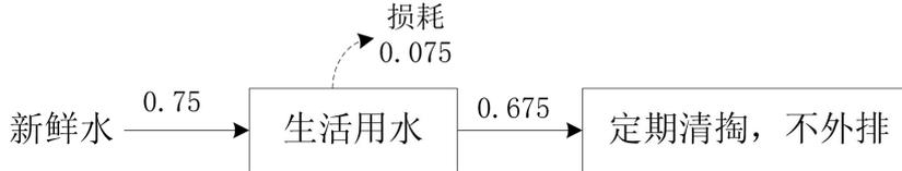
图 1 本项目水平衡图
