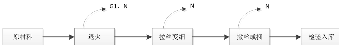
图 2-4 现有工程生产工艺流程图及产污环节图
